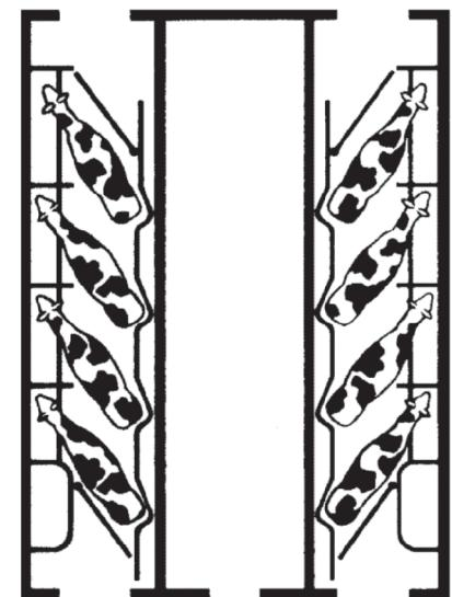
Установка состоит из станочного оборудования, вакуумной системы, вакуумного насоса, молочно-вакуумной системы, доильных аппаратов попарного доения, устройства управления процессом доения, молоко-приемника с фильтром, автомата промывки, системы идентификации животных, отводной линии молока для отвода молока от заболевших коров в отдельный молокопровод, системы автоматической промывки доильных аппаратов после доения каждого животного, селекционного устройства.
